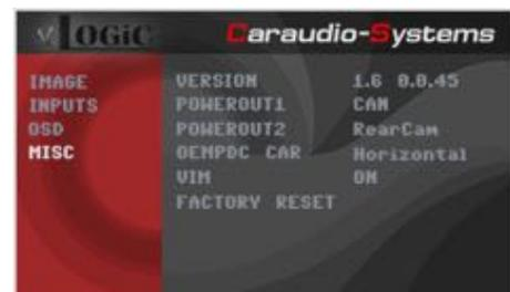
3 Bei einigen Fahrzeugen ist das Rückwärtsgangsignal nicht auf dem CAN-Bus vorhanden. Sollte das System nach der Installation und dem hier beschriebenen OSD-Setup (siehe nächstes Kapitel) nicht automatisch auf die Rückfahrkamera umschalten, so muss das weiße Kabel des Kabelsatzes TV-BM01 an das Rückfahrsignal (+12V des Rückfahrlichts) angeschlossen werden.
